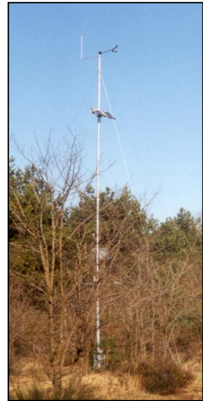
Abbildung 2.2.1-2: Meteorologische Messstation am Standort Taura, Freistaat Sachsen
