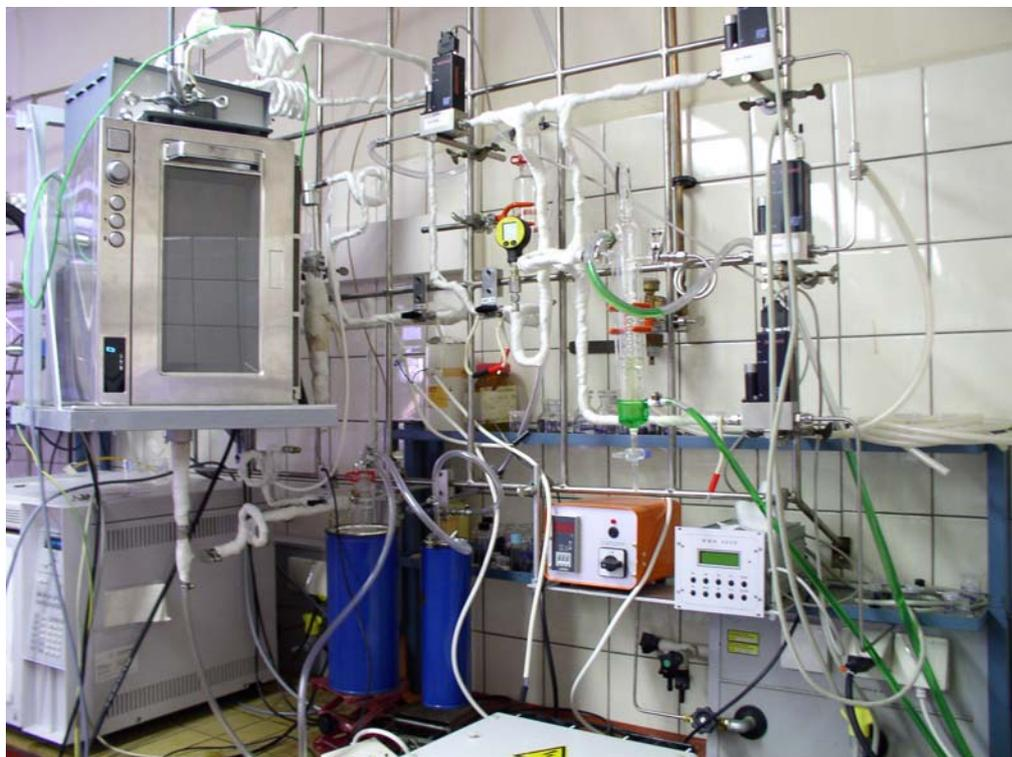
Abbildung 7.2: Apparatur für die mikrowellenassistierte Oxidation
