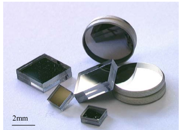
Bild 5-28 Gelötete BK7-Glasproben - Kontur
