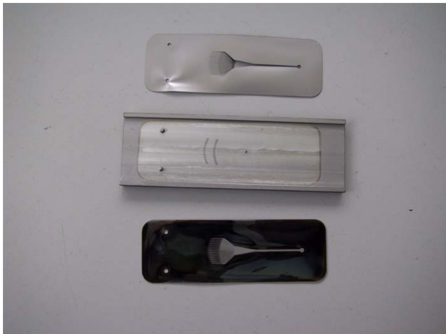
Abbildung 4-5 Positioniereinrichtung zum Besputtern der Glas-Mikrostrukturen mit Titan (Mitte), Mikrostruktur als Schattenmaske (oben) und besputterte Mikrostruktur (unten)
