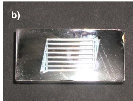
Abbildung D-10 Kovar® Mikroreaktor: a) nach dem Fräsen, b) mit anodisch aufgebondetem Borofloat®-Glasdeckel
