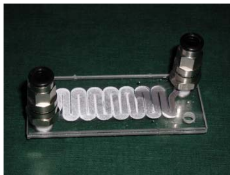
Abbildung 5-18 LTF Mikroreaktor mit fluidischen Anschlüssen (M6 Steckanschlüsse)
