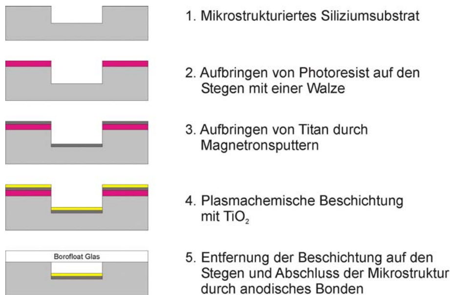
Abbildung 4-14 Herstellungsschema des AMT Mikroreaktors
