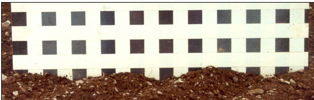
Abb. 3.4: Aufnahme eines Rauigkeitsprofils im Gelände
