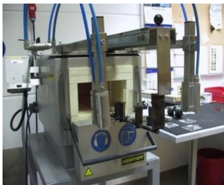
Abbildung 3-3: Thermischer Laborvorspannofen mit Scheibentransfervorrichtung zwischen Ofen- und Abkühlzone.
