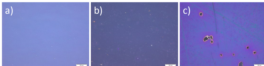
Abbildung 4-9: Mikroskopische Aufnahmen temperbarer low-E-Beschichtungen auf für 64 Wochen bei r.F. 5 a), 45 b) und 95% c) ausgelagertem Floatglas.
