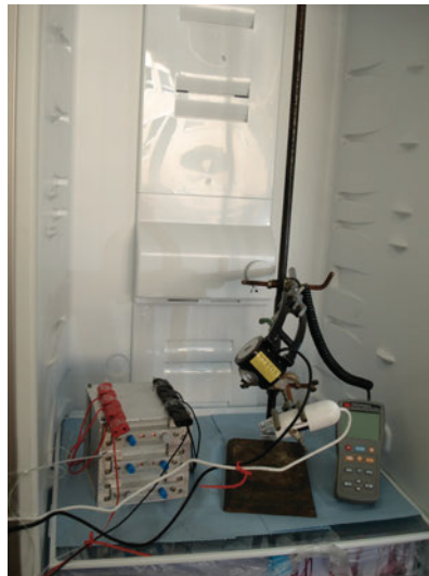
Abbildung 4.16: Versuchsaufbau zur Bestimmung der Temperaturabhängigkeit.
