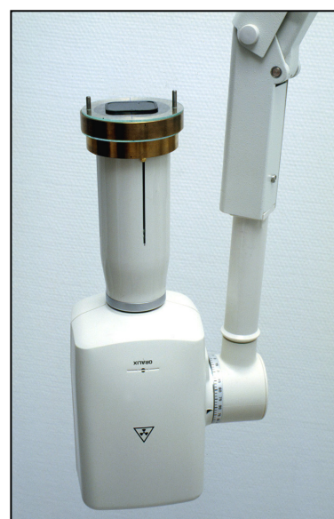
Abb. 1: Vorrichtung zur standardisierten Anfertigung von Röntgenbildern in vitro.
