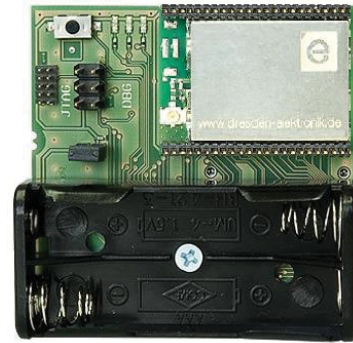
Abb. 8 Controller-Board mit dem ATmega128RFA1
