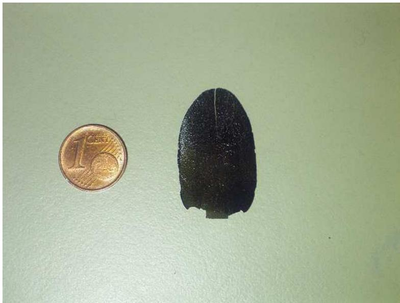
Abbildung 5.1: Größe eines typischen Flakes.
