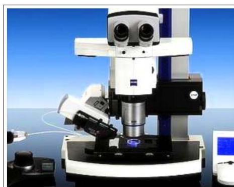
Abb. 22: Stereomikroskop mit Mikromanipulationseinheit („Aureka“) [Q14]
