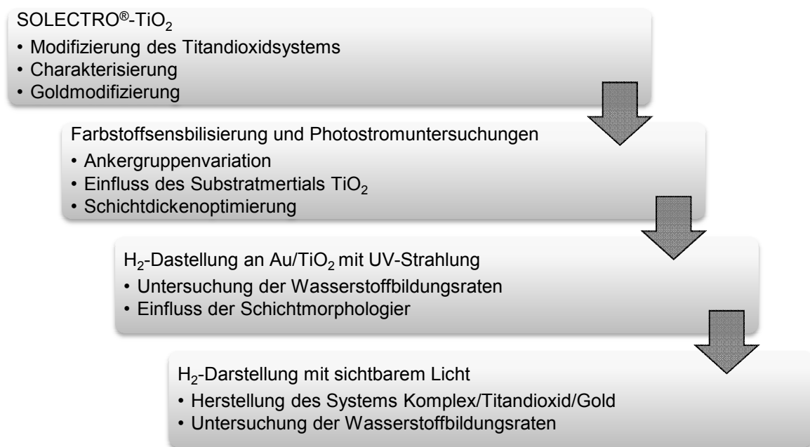
Abbildung 2-5: Darstellung des Arbeitsweges zum Aufbau eines Photokatalysators für die Wasserstoffdarstellung mit sichtbarem Licht.
