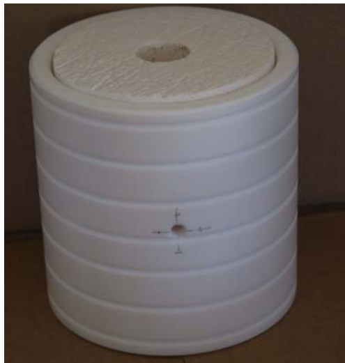
Abb. 3.2-7: Mikrowellentransparente Isolierung im Teflonbecher
