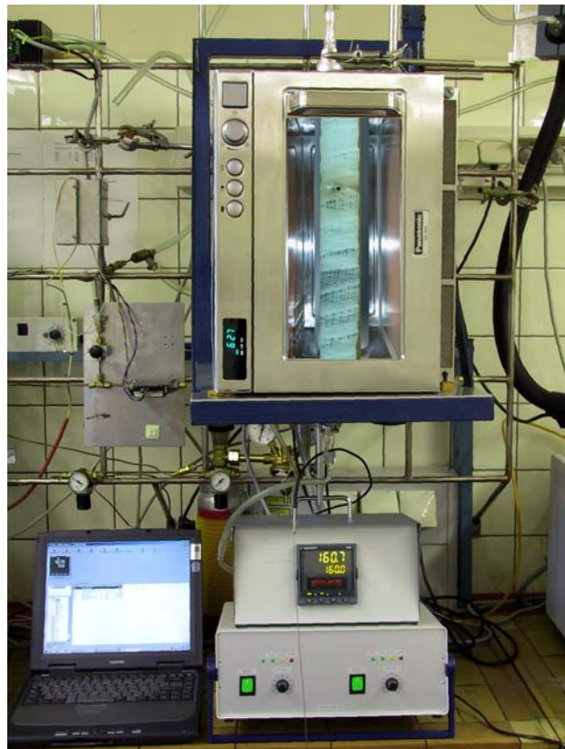
Abb. 3.2-2: Versuchsaufbau Mikrowellenreaktor Panasonic® (NE-1846) mit Quarzglasreaktor
