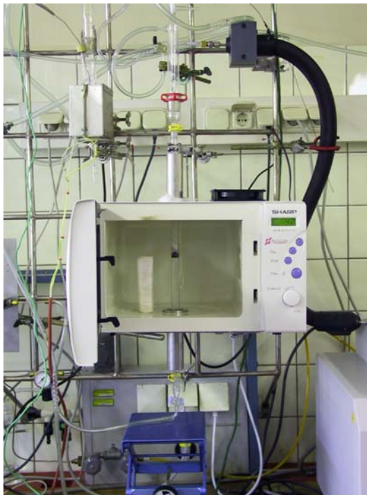
Abb. 3.1-1: Mikrowellenversuchsreaktor (modifizierte Haushaltsmikrowelle Sharp® RS 233)
