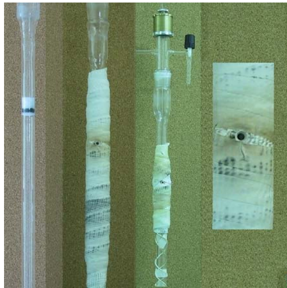
Abb. 3.3-2: Verwendete Quarzglasreaktoren (ohne Isolierung, MW-Reaktor, KH-Reaktor) und Ausschnittsvergrößerung (Durchsichtfenster zur Temperaturmessung mit dem IR-Pyrometer)
