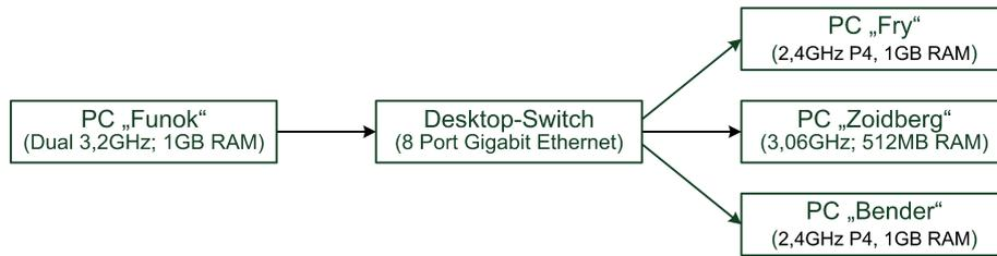
Abbildung 6.17: Messaufbau zur Bestimmung des Multicasteinflusses auf  $t_{\text{Knoten}}$
