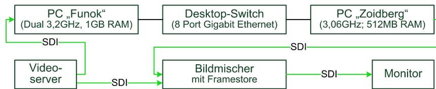
Abbildung 6.19: Messaufbau Gesamtsystem-Latenzmessung
