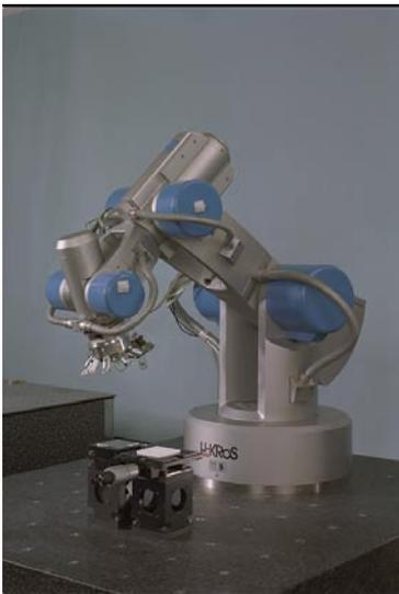
Abb. 6.1 Präzisions-Sechs-Achsen-Knickarm-Roboter
