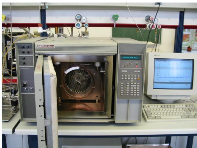
Abbildung 5.4: Gaschromatograph HP5890 FID
