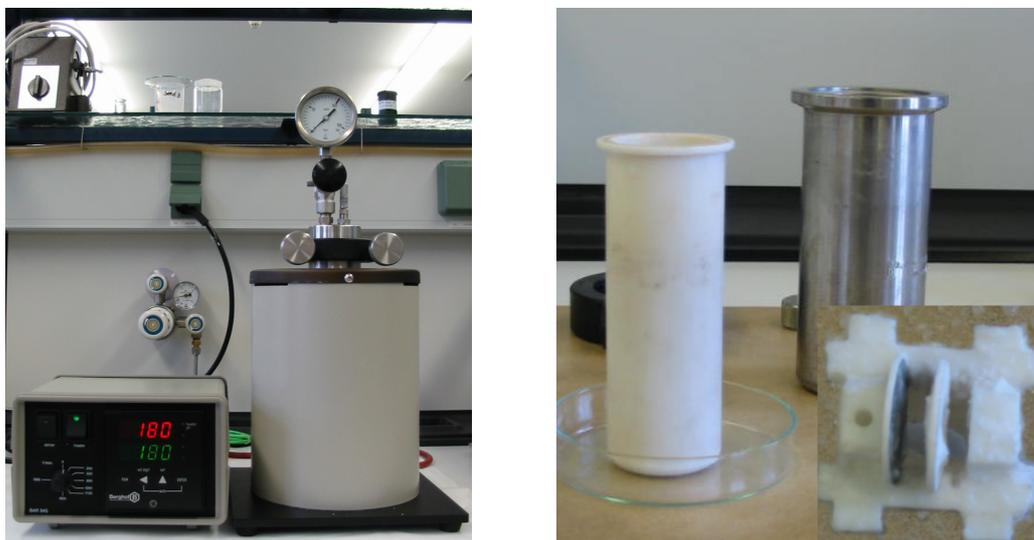
**Abbildung 5.1:** Berghof-Autoklav (links), Edelstahlbehälter und Tefloneinsatz (rechts), Teflonhalter (2 x 2 cm)
