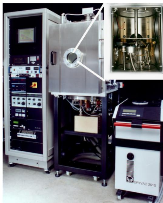
**Abbildung 5.2:** Sputterup 500, Innenansicht rechts oben
