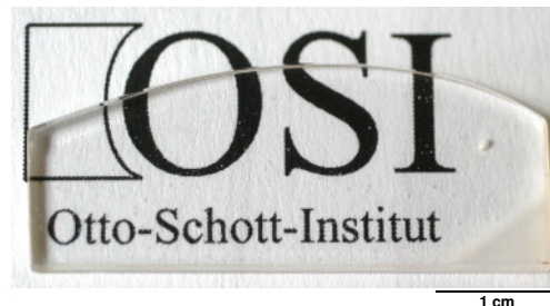
Abbildung 30: Transparente Glaskeramik der Probe B6 nach Temperaturbehandlung bei 560 °C für 20 h.
