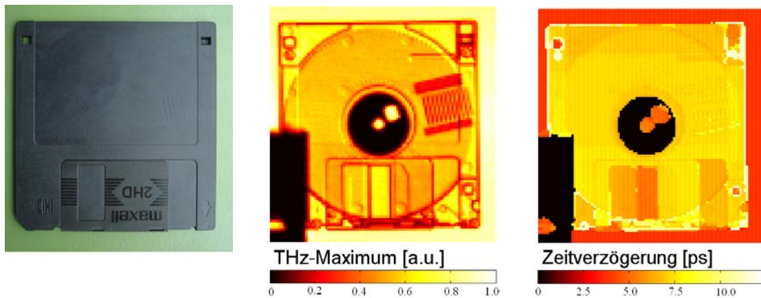
Abb. 2.8: Ortsaufgelöste Messung einer Probe: Für eine Diskette (Foto links) ist die Amplitude (Mitte) und Zeitverzögerung (rechts) der THz-Pulse nach Durchgang durch die Probe dargestellt.
