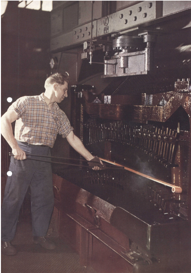
Bild 4.24: Ausbiegen und Härten eines Federblattes in einer Rahmenmaschine [4.36]
