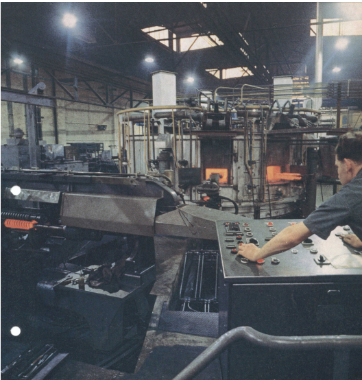
Bild 4.28: Ältere kontinuierliche Schraubenfedernfertigungsanlage mit Rundofen [4.37]
