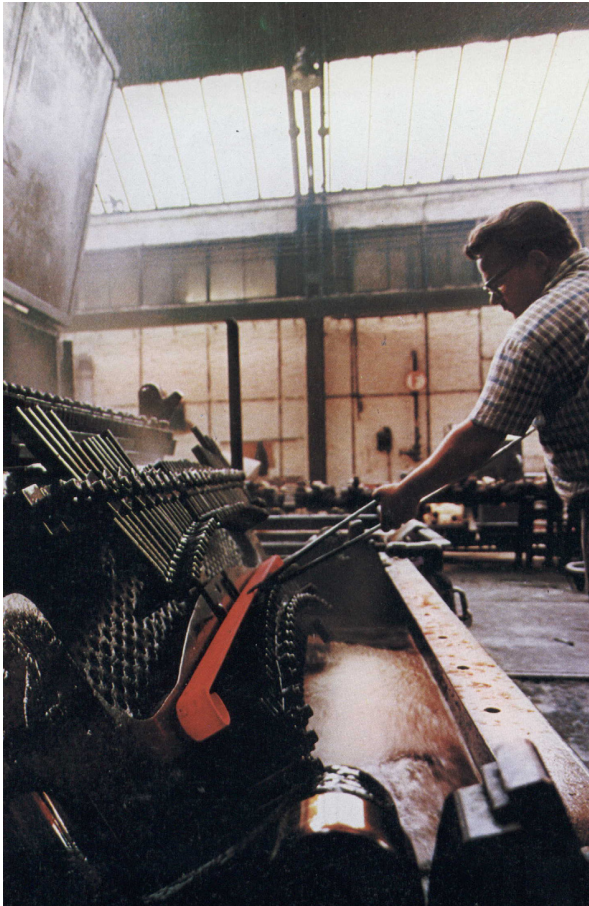
Bild 4.23: Ausbiegen und Härten eines Federblattes in einer Trommelmaschine
