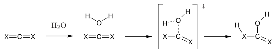
Schema 3.1: Unkatalysierte Reaktion mit Wasser über einen konzertierten, viergliedrigen Übergangszustand. X = CH 2 , NH, O, S
