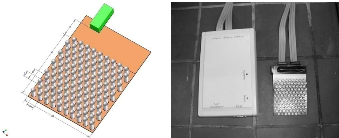
Abbildung 18: Konstruktionsschema des LED-Array für den Minireaktor und von Innotas Produktions GmbH umgesetztes LED-Array
