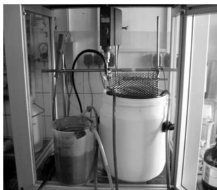
Abbildung 28: Beschichtungsanlage mit zwei Badeinsätzen; links das 5 L Bad und rechts das 20 L Bad
