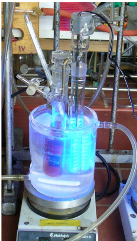
Abbildung 2.67: Aufbau der Versuchsapparatur zur katalytischen Isopropanol-Oxidation
