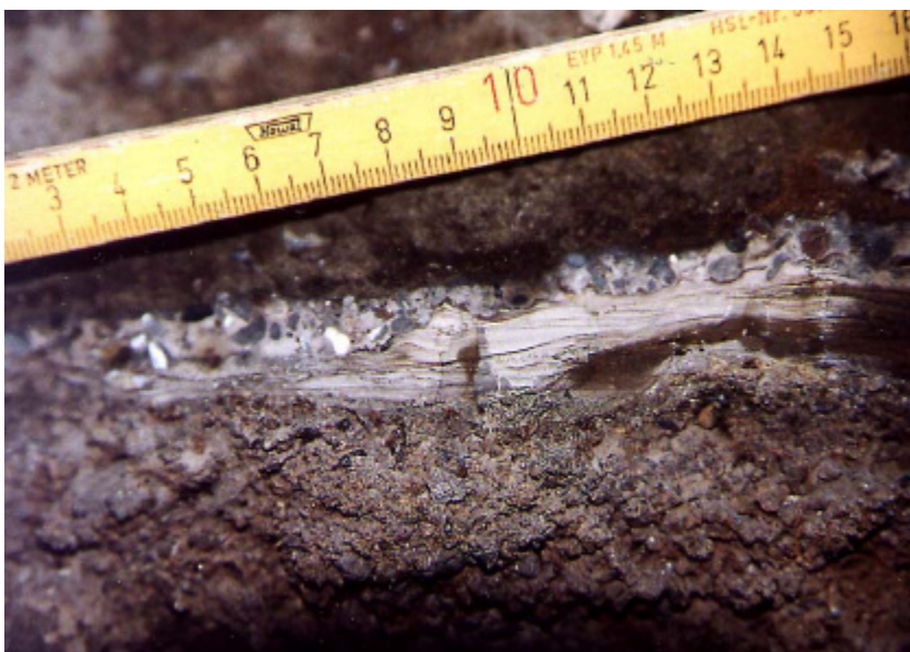
Abb. 2-5: Makroaufnahme der Diskordanz zwischen schlackigen Pyroklastika (unten) sowie vulkani- und epiklastischen Sedimenten (oben) im östlichen Abbaufeld der Lavasandgrube Cordel
