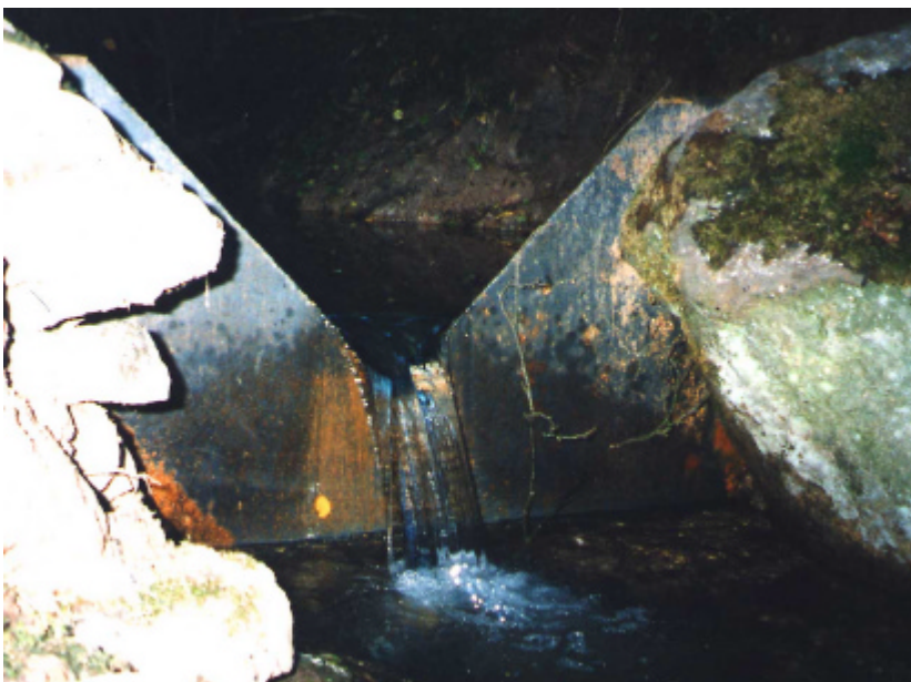
Abb. 5-2: Thompson-Überfallwehr an Messstelle 0 mit einem Abfluss von ca. 12 l/s zum Zeitpunkt der Aufnahme
