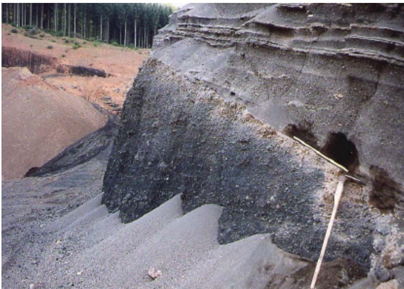
Abb. 2-4: Im östlichen Abschnitt der Lavasandgrube Cordel wird die Schichtgrenze zwischen den schlackigen Pyroklastika (unten) und vulkaniklastischen Sedimenten (oben) durch eine steil nach Nordnordwest einfallende Abscherungsfläche geprägt.
