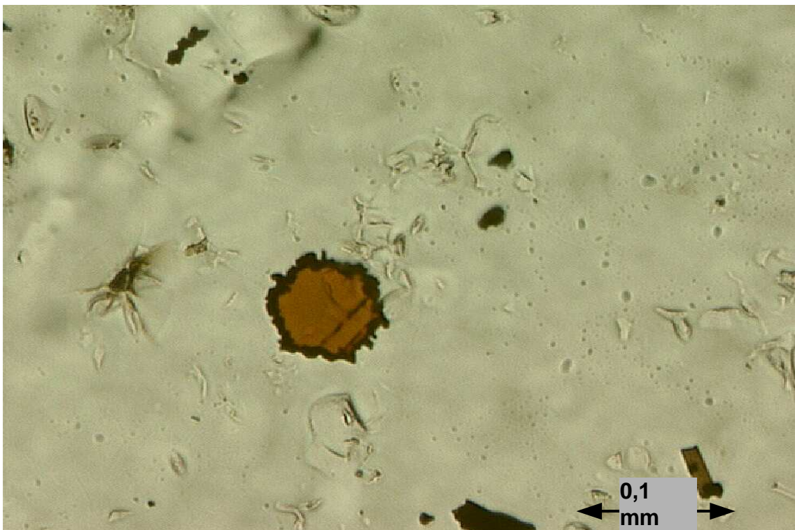
Abb. 3.2-2: Idiomorpher, sehr feinkristalliner neugesproßter Biotit der Matrix mit randlich angereicherten opaken Körnern; Probe Tü-98-11/1 (Typ B1).
