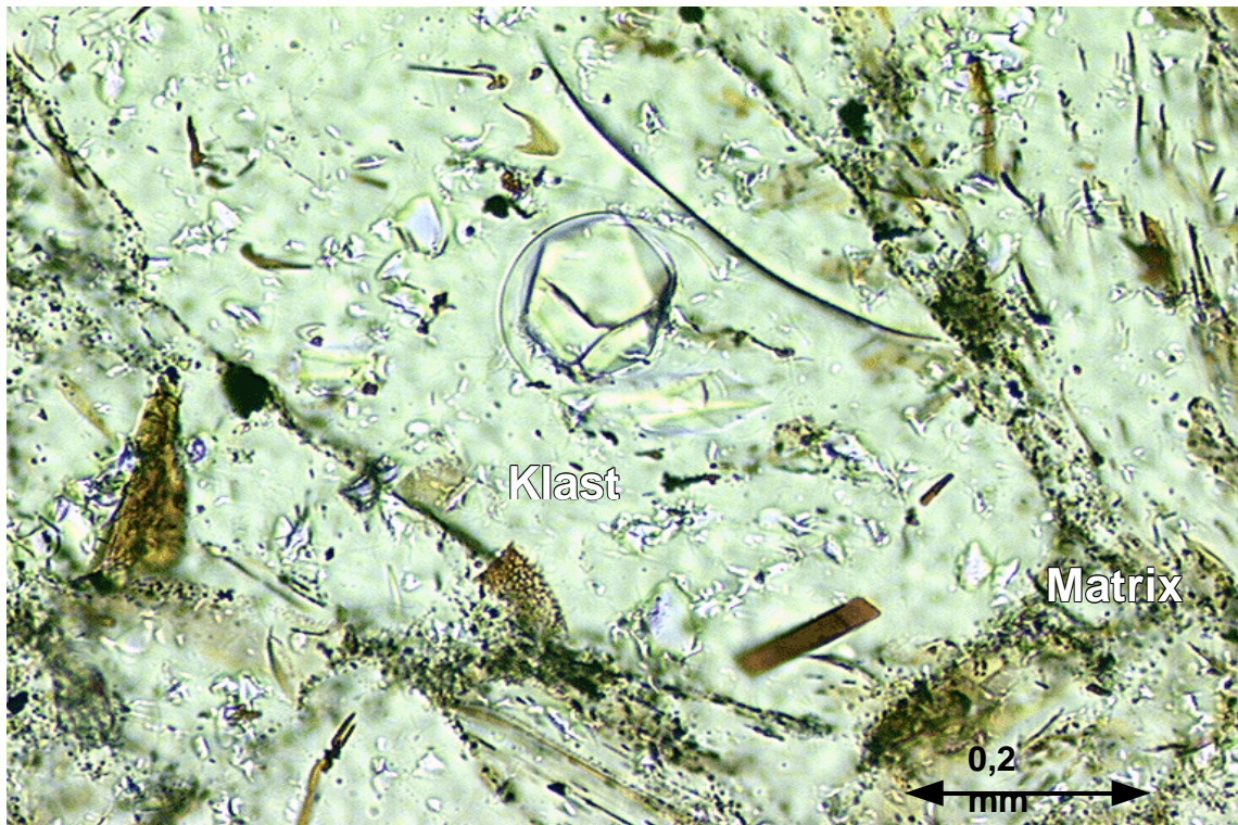
Abb 3.2-3: Ausschnitt mit idiomorphem Quarzkorn in einem Klast des Typs A2 der Probe Tü-98-11/1.
