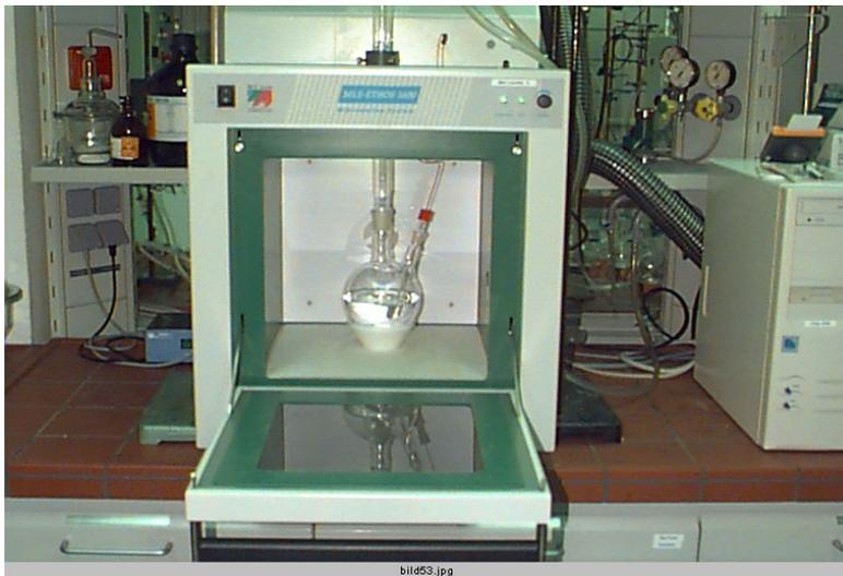
Abb.5-1. ETHOS 1600 mit Rückflussapparatur.
