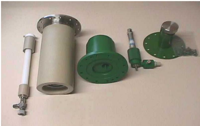
Abb. 6-3. Bestandteile des CFR: Reaktor, Mantel, Halterung, Proportionalventil, Standarddeckel.
