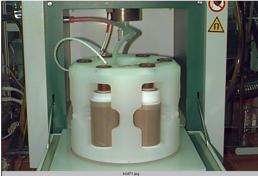
Abb. 6-1. Parallelreaktor HPR 1000/6 im Gerät ETHOS MR.
