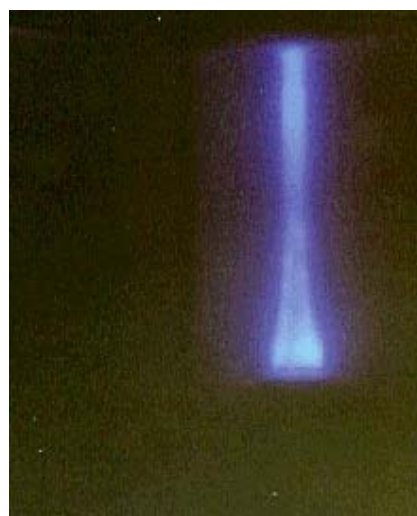
Abbildung 20 : Reflektiertes Ultraschallfeld des 850 kHz – Schwingers
