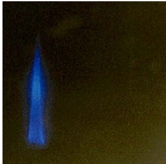
Abbildung 19 : Ungestörtes Ultraschallfeld des 850 kHz – Schwingers
