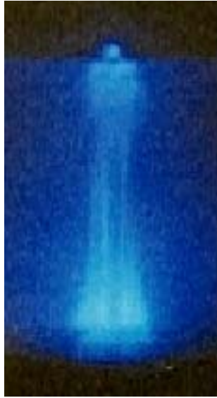
Abbildung 4 : Visualisierung des Ultraschallfeldes bei Verwendung einer alkalischen Luminollösung (500 kHz – Schwinger; Meinhardt Ultraschalltechnik, Leipzig)
