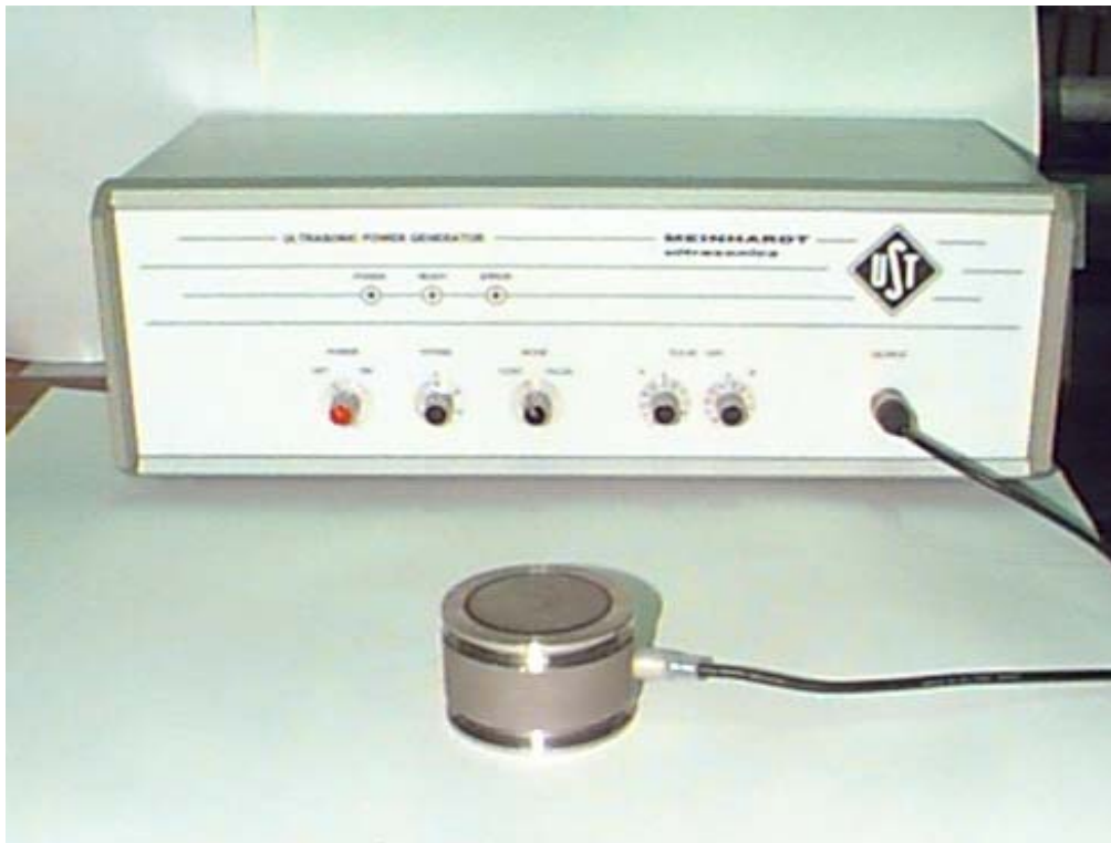
Abbildung 9 : 850 kHz – Planschwinger mit Ultraschallgenerator (Meinhardt Ultraschalltechnik, Leipzig)
