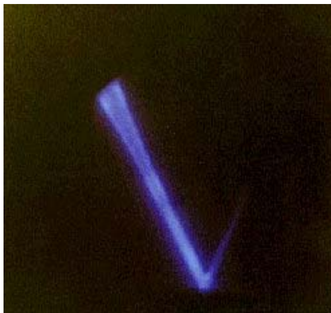
Abbildung 22 : Fast vollständige Reflexion des Ultraschallfeldes an Glasflächen
