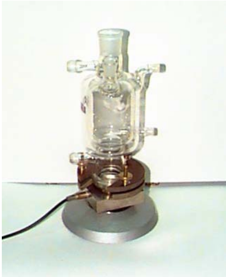
Abbildung 10 : Multifrequenzschwinger mit angeflanschem Glasreaktor (Meinhardt Ultraschalltechnik, Leipzig)
